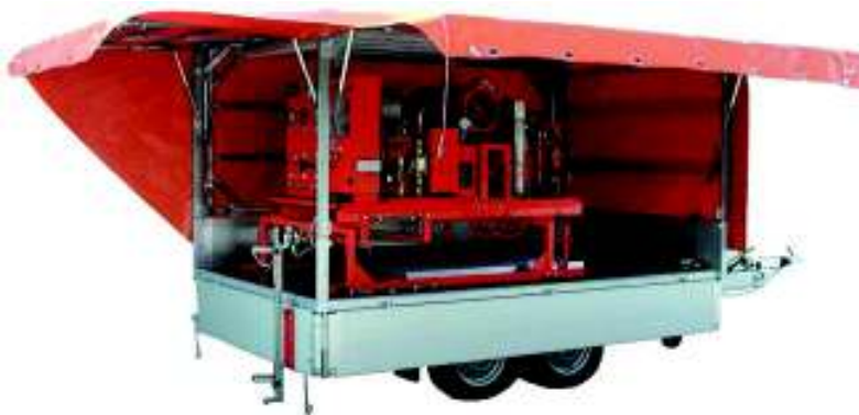
B120R02 con bodega para 4 botellas de SF 6 B086R11 sobre remolque B088R04
